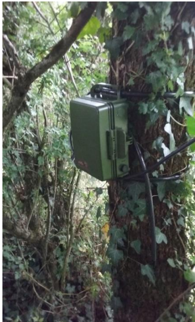
Figure 9 : Installation d'enregistreur continu SM4BAT
