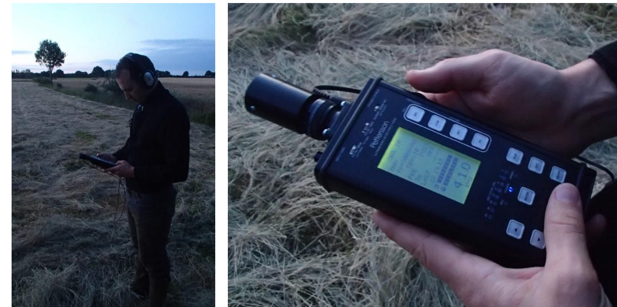
Figure 8 : Exemple de Point d'écoute de 15 à 20 min à la batbox Pettersson D1000X – Photographies prises hors site
